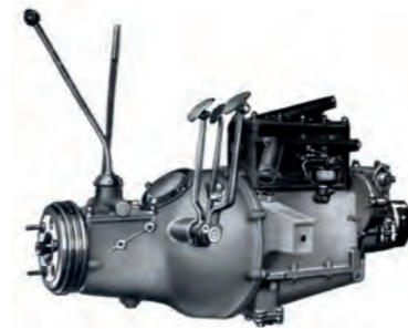
Seitenansicht des Motors, Vergaserseite mit Wechselgetriebe
