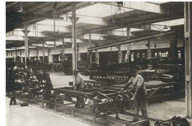
Montageband für den Zusammenbau von Federn und Rahmen, hier am Beispiel des Opel 10PS
