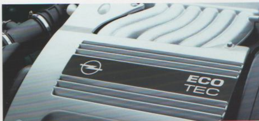
V6-ECOTEC-Motor. Das kompakte High-Tech-Triebwerk mit 2.5 Liter Hubraum, 24 Ventilen und 125 kW (170 PS).
