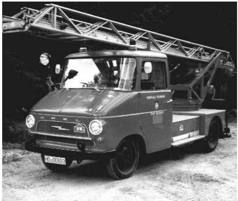
Drehleiter DL 18 Opel Blitz 1,9 to Bj. 1962, 6 Zylinder, 70 PS Magirus Stahlleiter mit 18 Meter Steig- höhe. Eingesetzt von 1962 bis 1994 von der FFW Weilburg/Lahn. Jetzt Betriebs- feuerwehr Medidenta Schramm & Co.
