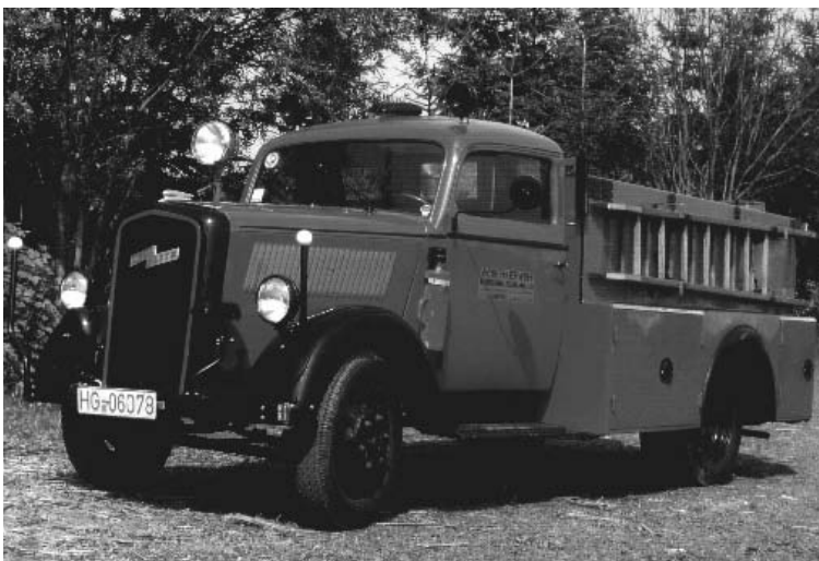
Kraftzugspritze KzS 8 Opel Blitz 1,5to Bj. 1939, 6 Zylinder, 55 PS Metz-Kraftzugspritze mit angehängter Tragkraftspritze 800 l. Eingesetzt vom Reichs-Luftfahrtministerium in Frankfurt am Main, danach bis 1976 bei der FFW Bad-Vilbel-Gronau. Von 1976-1989 Werkfeuerwehr Medidenta Schramm & Co. Oberursel
