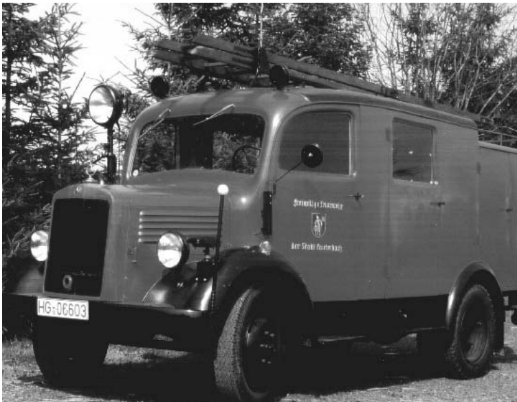
Leichtes Löschgruppenfahrzeug LLG Daimler Benz L 1500 Bj. 1942, 6 Zylinder, 45 PS Daimler Benz Aufbau, bis 1978 bei der FFW Lauterbach im Einsatz. Erstes Feuerwehrfahrzeug des Altkreises Lauterbach
