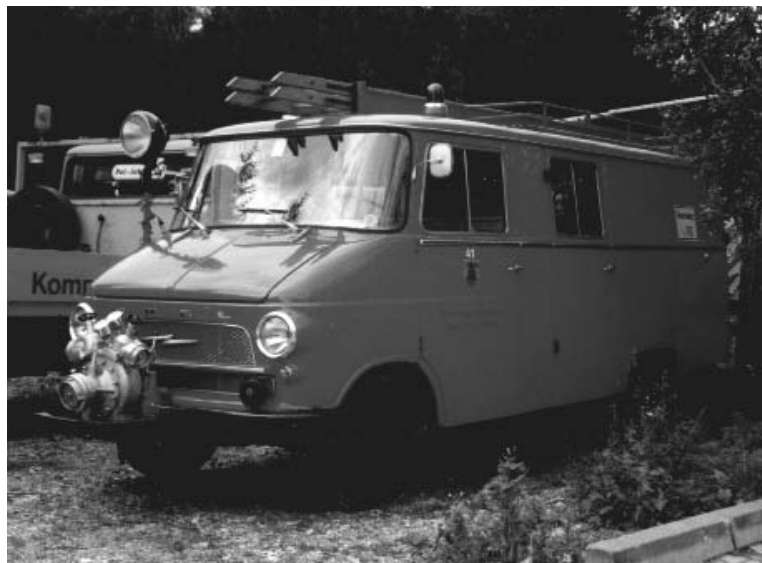
Löschgruppenfahrzeug LF 8 Opel Blitz 1,9 to Bj. 1964, 6 Zylinder, 70 PS Magirus Löschgruppenfahrzeug LF8 Vorbaupumpe 800 l. Eingesetzt von 1964 bis 1998 von der FFW TanniRöhn.
