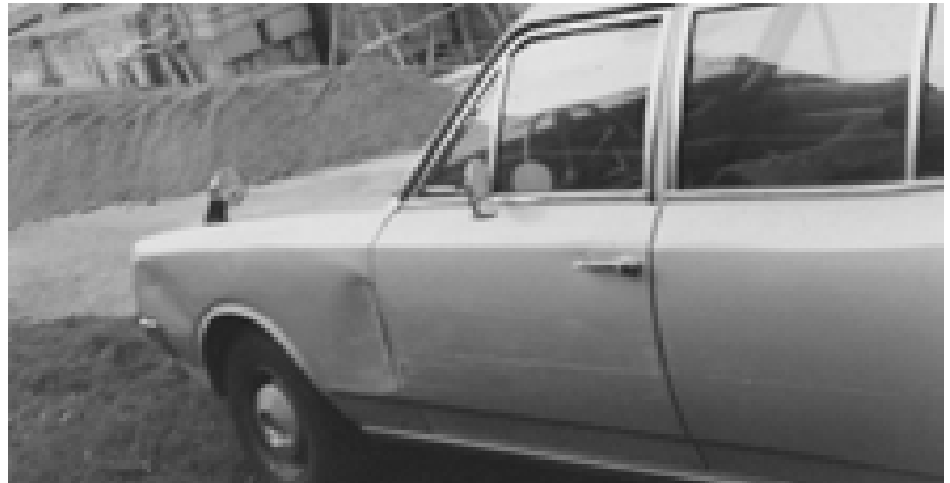
Rekord C mit „Abnähern“ am Kotflügel und an den Türen
